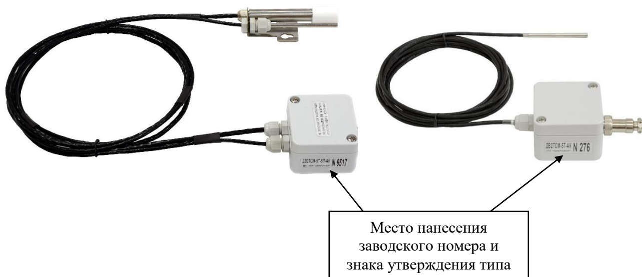
Рисунок 4 – Общий вид преобразователей исполнения 5Т-5П-АК (слева) и 5Т-АК (справа, исполнение без канала измерения относительной влажности)
