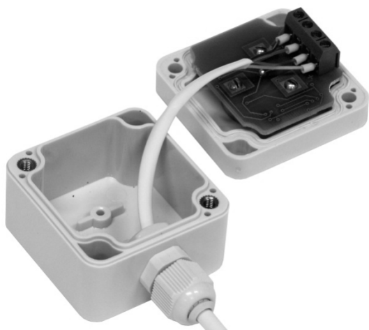
Рис. 8. Подключение кабеля к преобразователю интерфейса.
