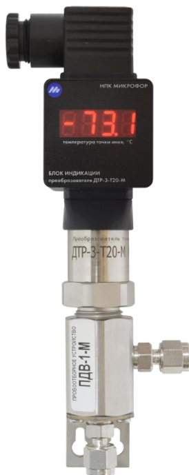
Рис.1. Внешний вид блока индикации, подключенного к преобразователю ДТР-3-Т20-М, установленного в пробоотборное устройство ПДВ-1-М-А.
