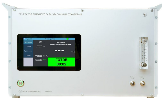
Рисунок 2 – Внешний вид генератора влажного газа эталонного Суховой-4В в настольном исполнении с поплавковым ротаметром на передней панели.
