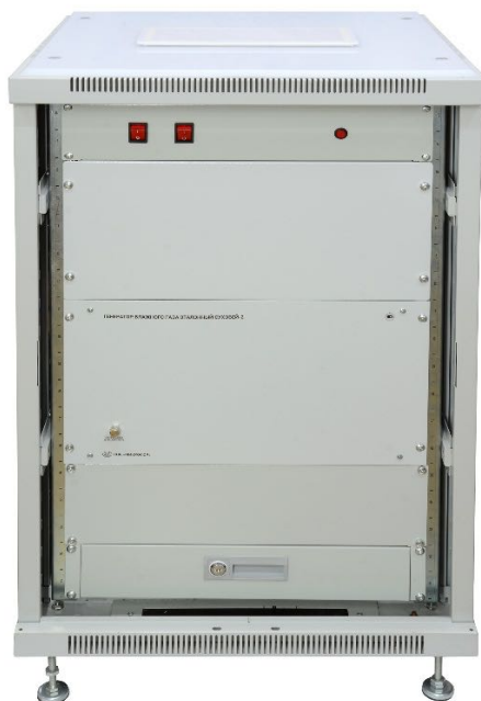
Рисунок 3 – Внешний вид генератора влажного газа эталонного Суховой-4В стоечного исполнения, установленного в 19” стойку с термостатируемой измерительной камерой.
