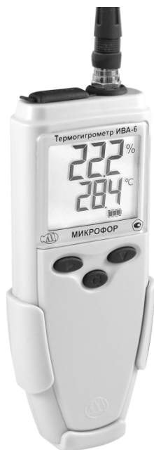
Рис.13. Настенная установка термогигрометра ИВА-6АР на кронштейне.
