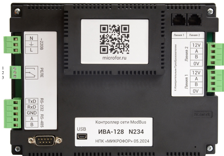
Рис.5. Расположение разъемов для подключения контроллера.
