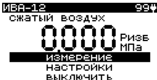
Рис. 6. Меню управления гигрометром.
