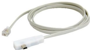
Рис.8. Адаптер КИ-3 для связи термогигрометров ИВА-6А и ИВА-6Н с измерительной системой.
