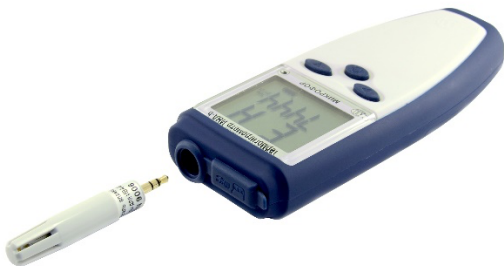
Рис.3. Извлечение преобразователя термогигрометра ИВА-6Н из блока индикации при поверке.
