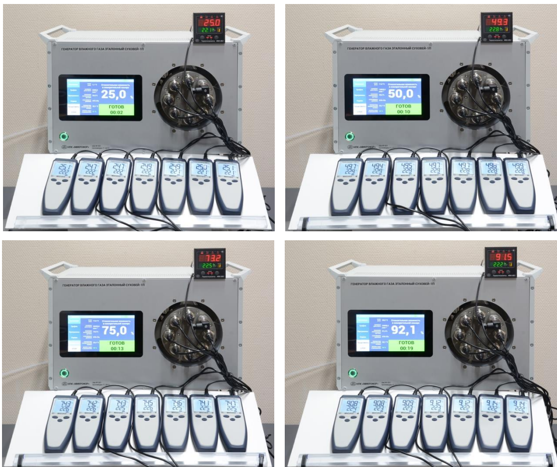
Рисунок 10 – Воспроизведение остальных значений относительной влажности в соответствии с методикой поверки.
